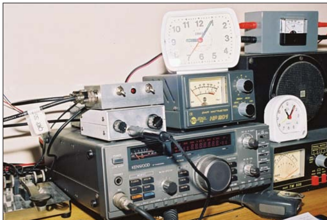
Vista del amplificador lineal situado sobre transceptor QRP. Ambos situados sobre un transceptor Kenwood TS-140-S.
