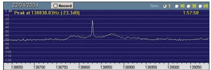
Figura 1: Espectro de la DCF39 medido con Spectran (www.weaksignals.com). Esta señal será nuestra baliza en la banda que, como se puede apreciar, levanta muchos dBs por encima del ruido. Para más detalles, consultar el texto.
