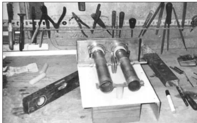
FOTO 2: Mecanizada totalmente la base "B" soportando al tabique "G" con la bobina L1, el condensador CP y la doble grapa con su soporte central de teflón. Observar entre el martillo y el nivel los soportes de L4.
