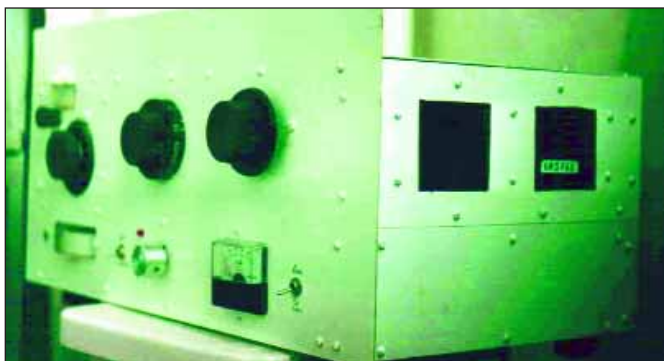
FOTO 9: Vista del acabado final. Confieso que podría haber terminado mejor, por eso retoqué con pintura blanca tornillo a tornillo con el ánimo de dejar lo mejor posible. Ver en el "tabique" los orificios de salida aire de refrigeración.
