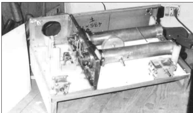
FOTO 3: Junto al orificio visible en el lateral "F" de entrada de aire aportado por la turbina, observad los dos orificios para recibir a los PL de entrada y salida de RF en los extremos, y los pilares que soportan a L3 — L2 con el condensador de 15 x 15 sobre su soporte aislante. Observad también el lijado de los extremos de las chapas y los angulares que las unen.
